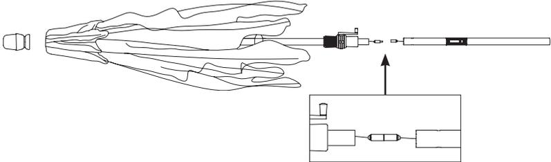
Insérer le poteau inférieur dans le poteau du dais / du cadre principal. **REMARQUE:** S'assurer que le socle de batterie sur le poteau inférieur est aligné avec le commutateur ALLUMÉ / ÉTEINT et le port USB du boîtier. Aligner le bouton avec le trou et enclencher.
