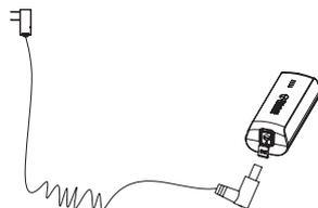
**État de la pile:** Les voyants de la pile indiquent le niveau de charge. Quatre voyants indiquent une charge complète, tandis qu'un indique une pile déchargée. Lorsque le niveau de la pile est faible, vous pouvez la charger lorsqu'elle est fixée au cadre ou retirée du cadre à l'aide du cordon d'alimentation fourni.
